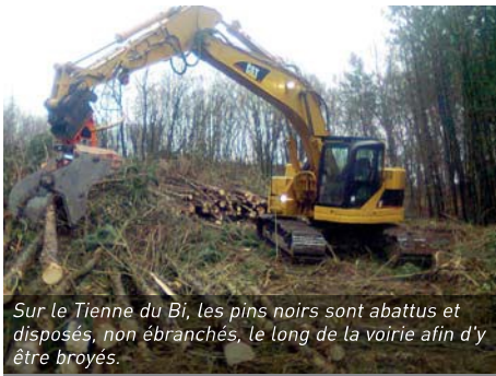
Les fourrés denses sont broyés à l'aide d'un broyeur forestier sur chenilles afin de réduire au maximum l'effet tassement sur le sol.
